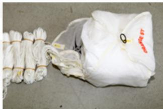
Hier ist zu beachten, dass die Leinen in die letzte Stoffbahn gelegt/umhüllt und mittels eines Gummis gesichert werden (Überwurfgefahr). Jedoch darf der Gummi nicht zu stark fixiert sein.
